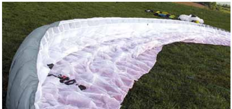
Caissons ouverts prêt à décoller.
